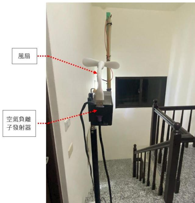
圖 6. 樓梯間空氣負離子發射器放置方式
