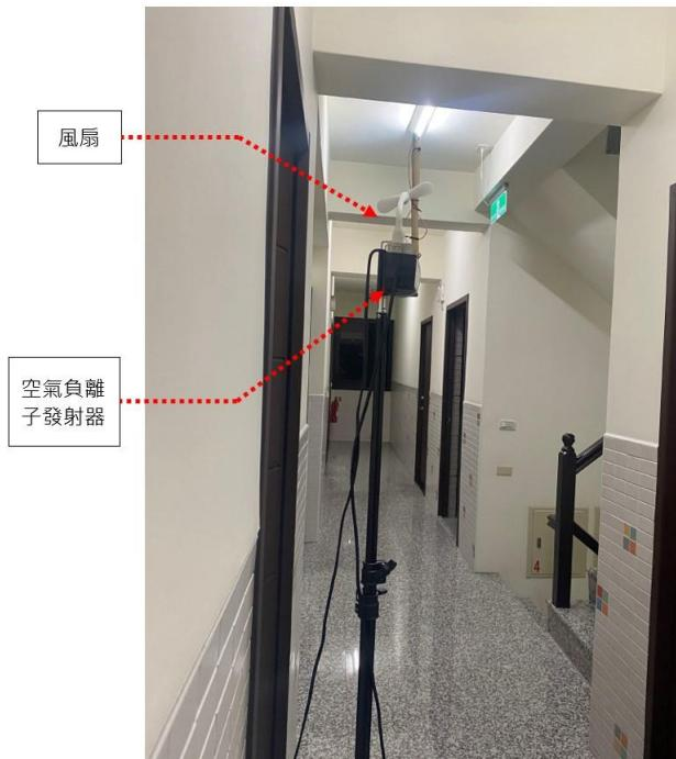
圖 4. 走廊空氣負離子發射器放置方式
