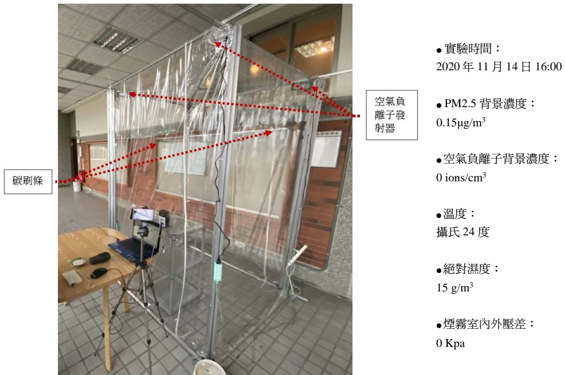
圖 2. 煙霧室之設備配置與邊界條件
