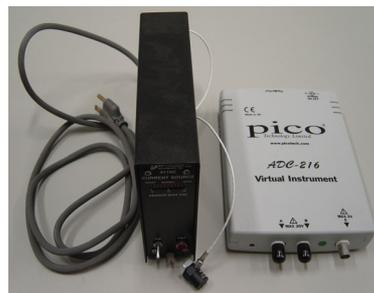
圖 4 PicoScope ADC-216 PC oscilloscope 振動量測儀器圖
