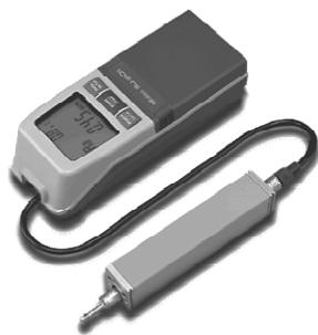
圖 2 MITUTOYO SJ-201 粗糙度測量儀
